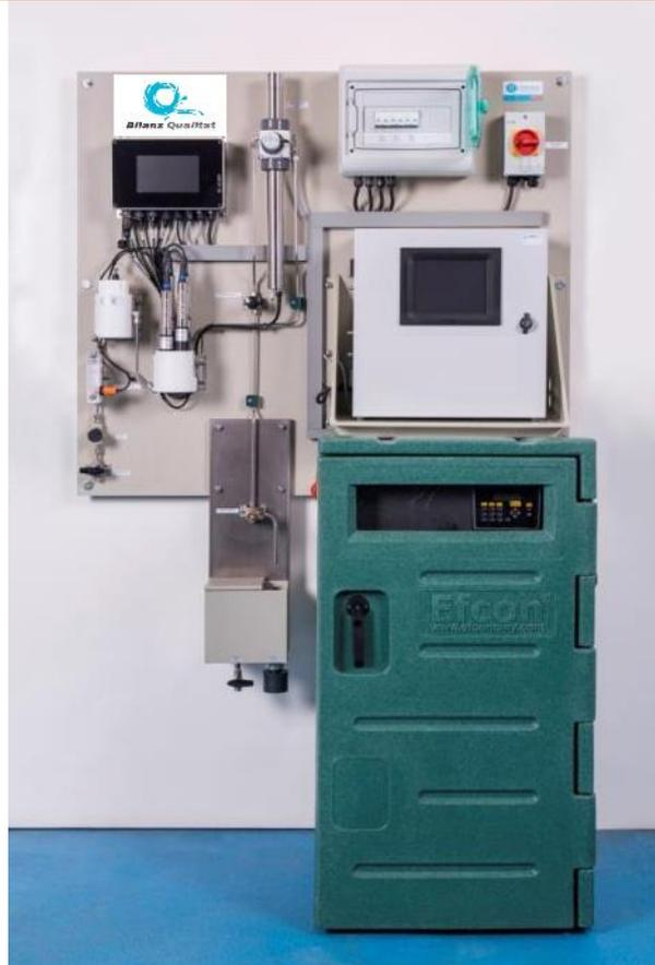
Estos equipos realizan la determinación tan rápida debido a que miden la reacción de fluorescencia producida por la actividad enzimática específica de  $\beta$ -galactosidasa (coliformes),  $\beta$ -glucuronidasa (E. coli) y fosfatasa alcalina (actividad total, biomasa) con el reactivo, de forma que, cuando la enzima está presente en la muestra, reacciona con los reactivos y se produce automáticamente un aumento en la fluorescencia.
